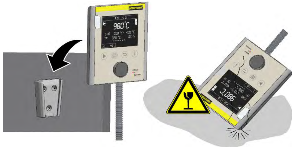
Fig. 42: Mettre le programmeur en place sur le support fixé sur le four (figure analogue)
